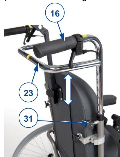
Figura 9 Regolazione dell'altezza delle maniglie di spinta
