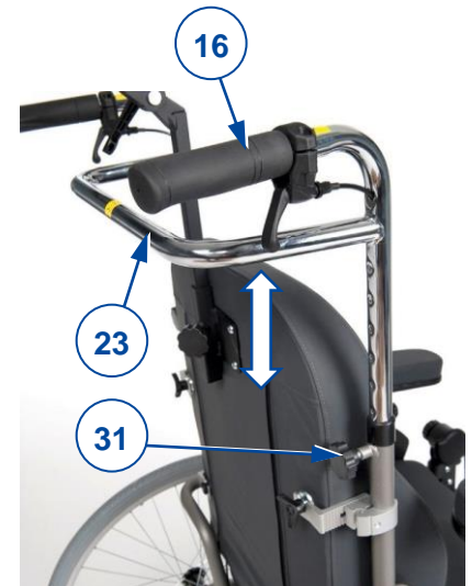
Figuur 9 De hoogte van de handgrepen aanpassen
