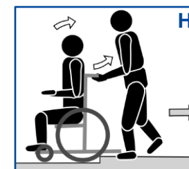
Obrázek 15 Přejíždění středně vysokých obrubníků s pomocí jedné osoby
