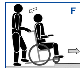
Obrázek 14 Přejíždění nízkých obrubníků s pomocí jedné osoby
