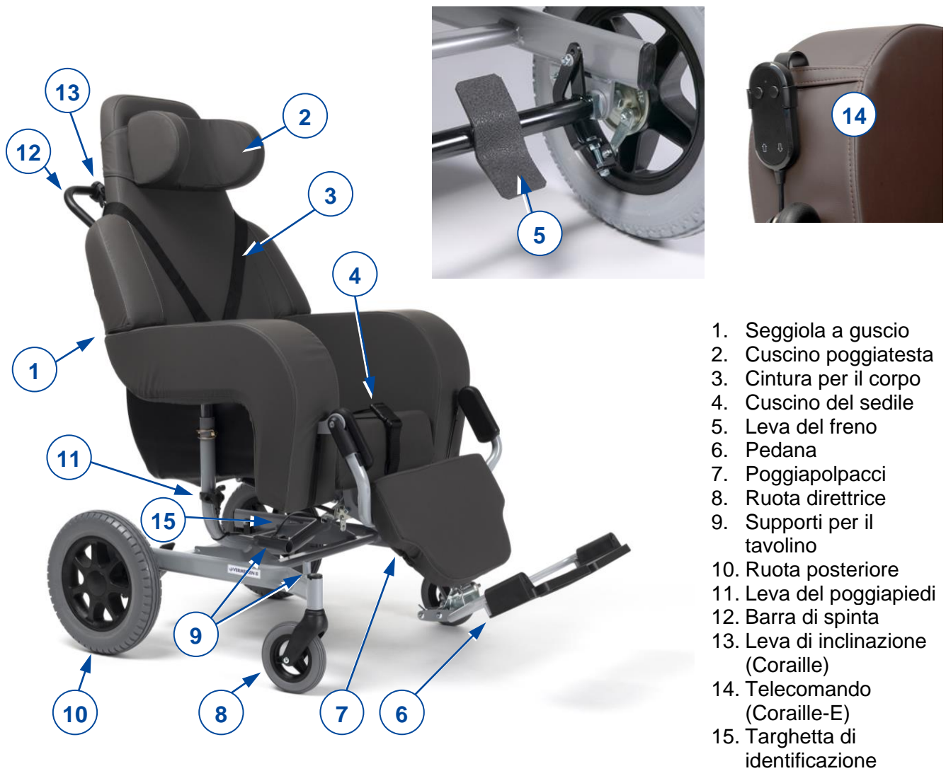
Figura 2 Componenti importanti - modello Coraille, Coraille-E
