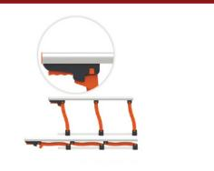
**Sponde a compasso** con meccanismo di abbattimento servoassistito realizzate in polimero e alluminio.
