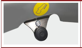
**Freno centralizzato motorizzato**, azionamento tramite comando a pedale.
